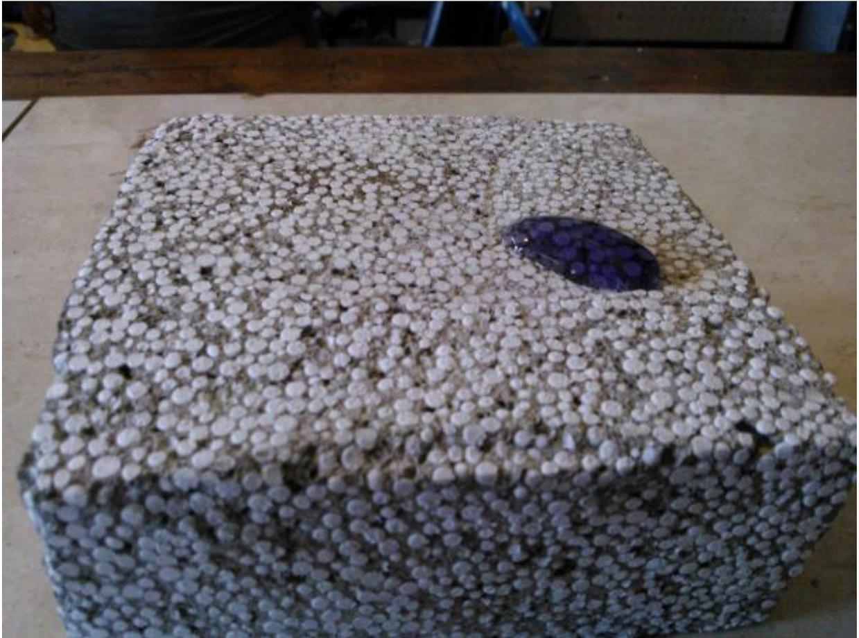
1- Imagen que muestra el comportamiento del agua (coloreada) sobre la superficie de **D 600**
