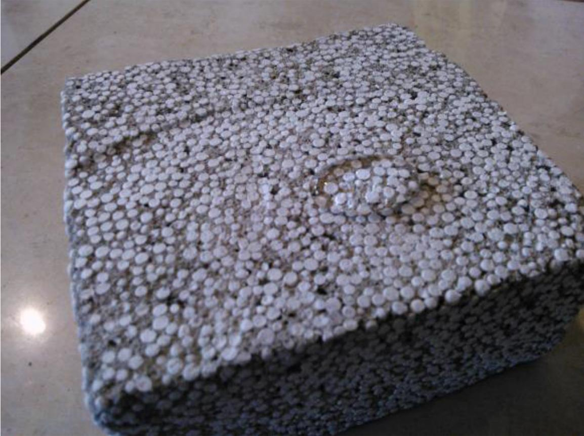
2- Además de su baja absorción capilar de agua se puede ver la distribución uniforme de las celdas de poliestireno que hacen de **D 600** el producto de mayor resistencia a la compresión con el más bajo coeficiente de conductividad térmica.
